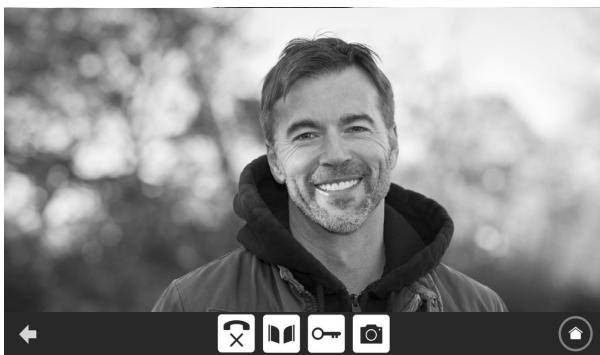
Pro přijetí hovoru stiskněte ikonu „Zvednout sluchátko“. Mikrofon vnitřního monitoru a reproduktor venkovního ovládacího panelu se aktivují až po přijetí hovoru.
