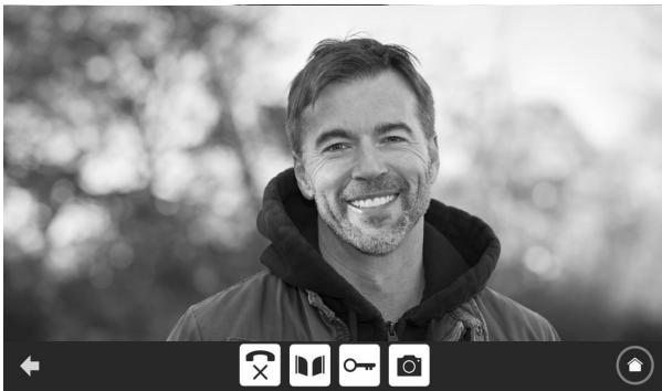
Aby nawiązać komunikację, nacisnąć na pictogram „odebranego telefonu”. Mikrofon monitora wewnętrznego i głośnika panelu uruchamia się po odebraniu połączenia.
